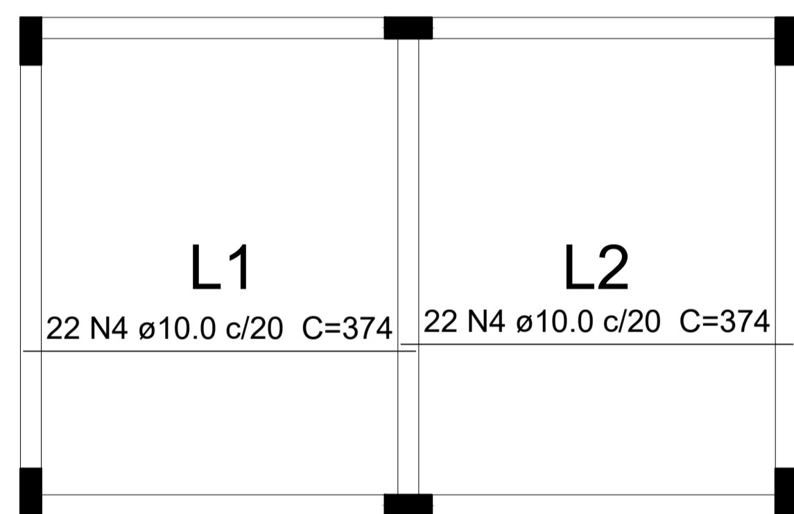
Armação Positiva das Lajes do Nível 5 (Eixo X) Escala 1/50
